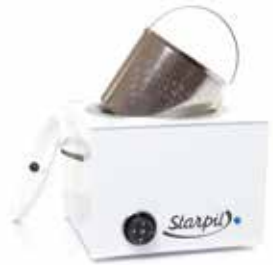
3010400009 FUNDIDOR DE CERA Carcasa metálica pintada Cubeta y filtro de aluminio 4 kg Medidas: 278 x 200 x 280 mm Potencia: 450w (220v-50Hz)
